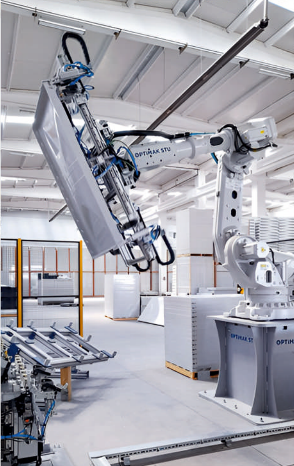
GRP-KOMPOZİT PANEL ROBOTİK DELME
